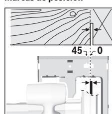
La marca de corte 0° (9) muestra la posición de la hoja de sierra en caso de corte rectangular. La marca de corte 45° (8) muestra la posición de la hoja de sierra en caso de corte de 45°.
