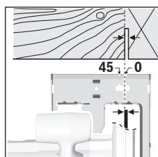
A marcação de corte 0° (9) indica a posição do disco de serra no corte em ângulo reto. A marcação de corte 45° (8) indica a posição do disco de serra no corte em 45°.
