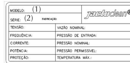
Na caixa elétrica do motor está afixado um adesivo contendo informações sobre o modelo da máquina, o nº de série, a pressão de trabalho, a tensão do motor e outras importantes informações.
