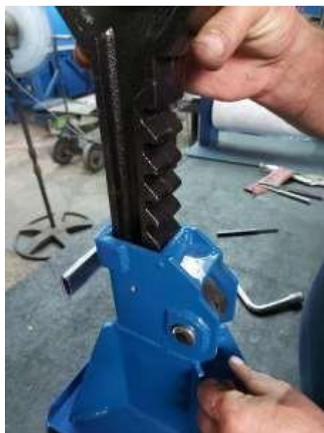
Figura 08 – Remoção da Haste
