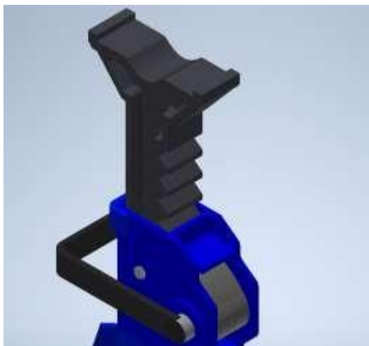
Figura 19 – Região de Apoio e Dentes da Haste (Cremalheira)
