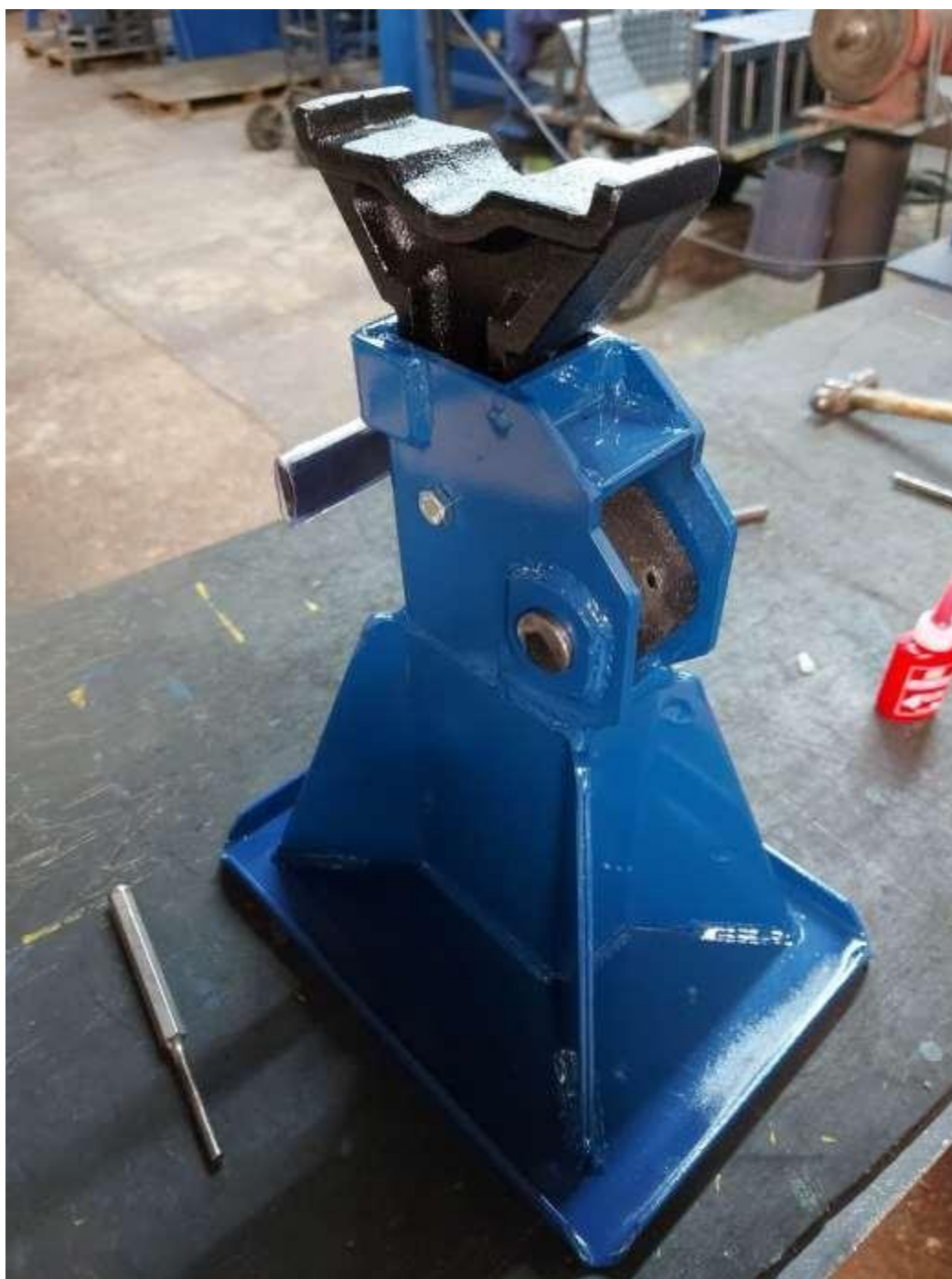
Figura 18 – Cavalete CP Montado
