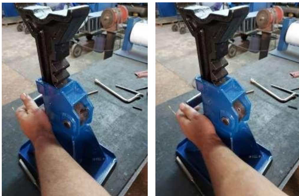
Figura 16 – Fixação do Pino Elástico na Castanha
