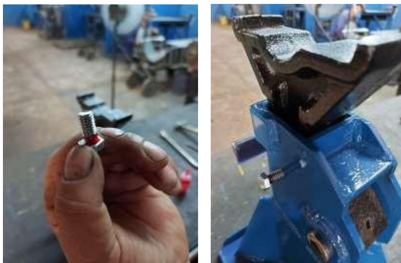
Figura 17 – Aplicação da Trava Química no Parafuso de Trava da Haste
