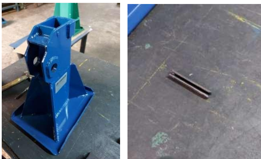
Figura 11 – Remoção do Pino Elástico Alojado Dentro da Base do Cavalete
