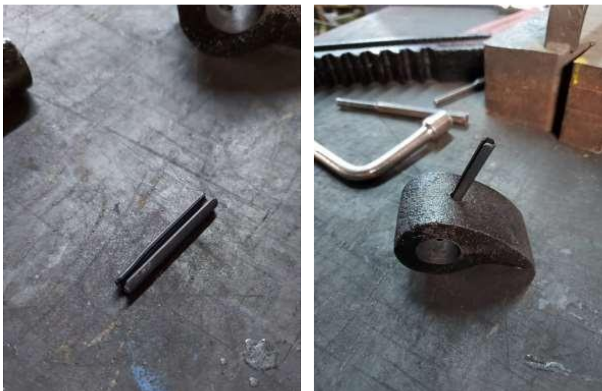
Figura 13 – Ajuste do Pino Elástico Novo
