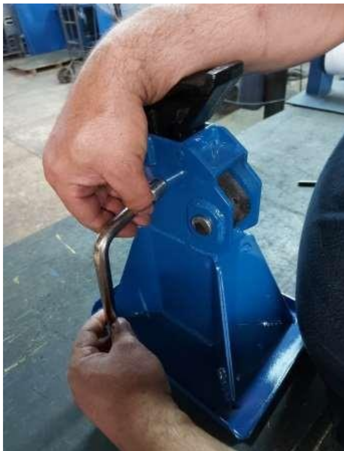
Figura 07 – Remoção do Parafuso de Trava da Haste
