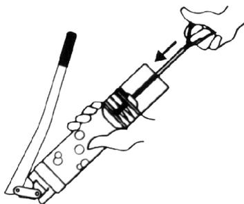
**04-**Após a liberação do ar preso, aperte inteiramente o cabeçote. Opere usando a alavanca manual.
